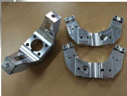
マシニング、ワイヤーによる精度物の複雑形状の加工
