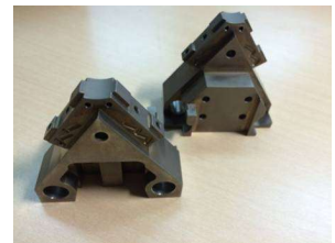
樹脂、アルミによる試作品
