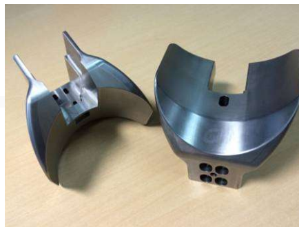
マシニング、ワイヤーによる精度物の複雑形状の加工
