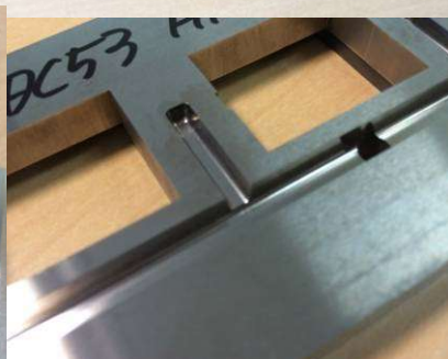
熱処理後の3D微細加工 R0.75 (DC53 HRC59~61°)
