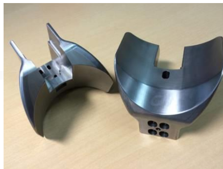
マシニング、ワイヤーによる高精度の複雑形状の加工
