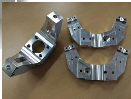
マシニング、ワイヤーによる高精度の複雑形状の加工
